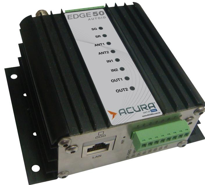
O Edge-50 Autoid é um leitor RFID UHF que opera conforme estabelece a Anatel, com uma frequência de 902-907 MHz, 915-928 MHz. Perfeito para aplicações de identificação veicular, principalmente por possuir os principais protocolos de comunicação utilizados na grande maioria das controladoras, e ainda enviar dados via comunicação TCP/IP. Pequeno em suas dimensões, porém, com um alto desempenho, o leitor Edge-50 Autoid suporta até duas antenas monoestáticas.
